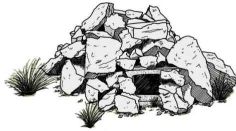
Figure 19 : Pierrier aménagé sur une base de parpaing creux
