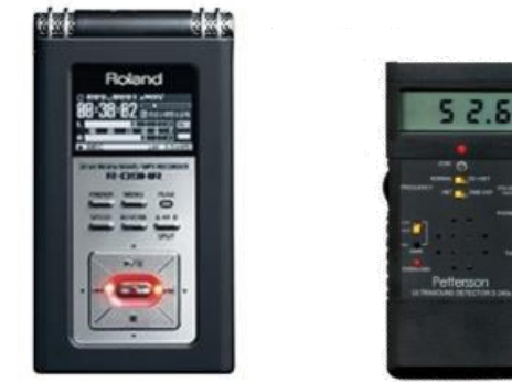
☞ Photographies 26 & 27: Détecteur à ultrasons Petterson® D240X et enregistreur Roland R-09UR
